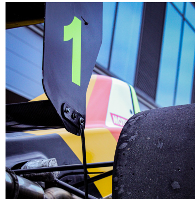
Formule Renault 2.0, coque carbone, moteur 2000 cm3, 200 CV pour 480 kg, vitesse de pointe : 250km/h, boîte de vitesse avec palettes au volant 6 rapports
